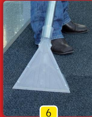
... und in einem Arbeitsgang wird die rent & clean Dosiermischung auf den Teppich aufgebracht und mit dem Schmutz abgesaugt. **Hinweis:** Düse nur ziehen.
